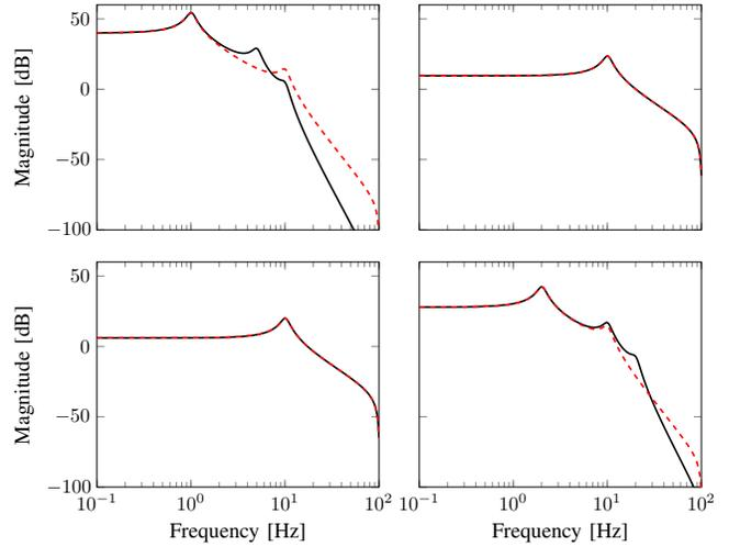
Fig. 3. Bode diagram of true system  $S_P$  (—) and model (---).
